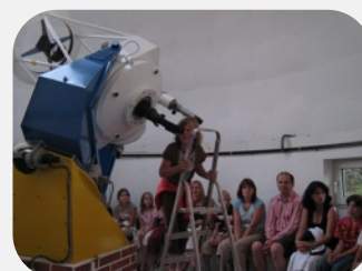
Das große Cassegrain Teleskop mit 50 cm Öffnung und 5 m Brennweite
